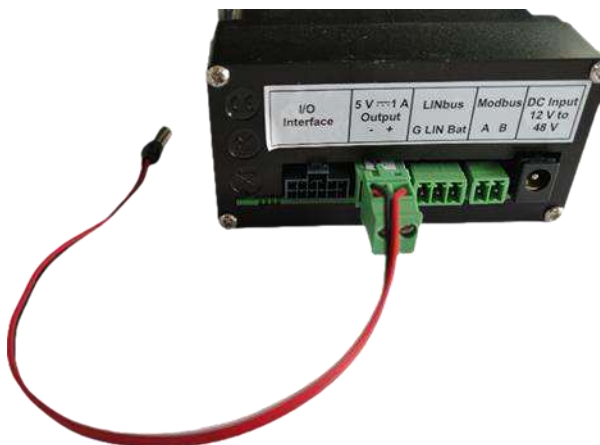
图 7 DC 带电缆的电源输出连接器，用于电源 M2M 连接
